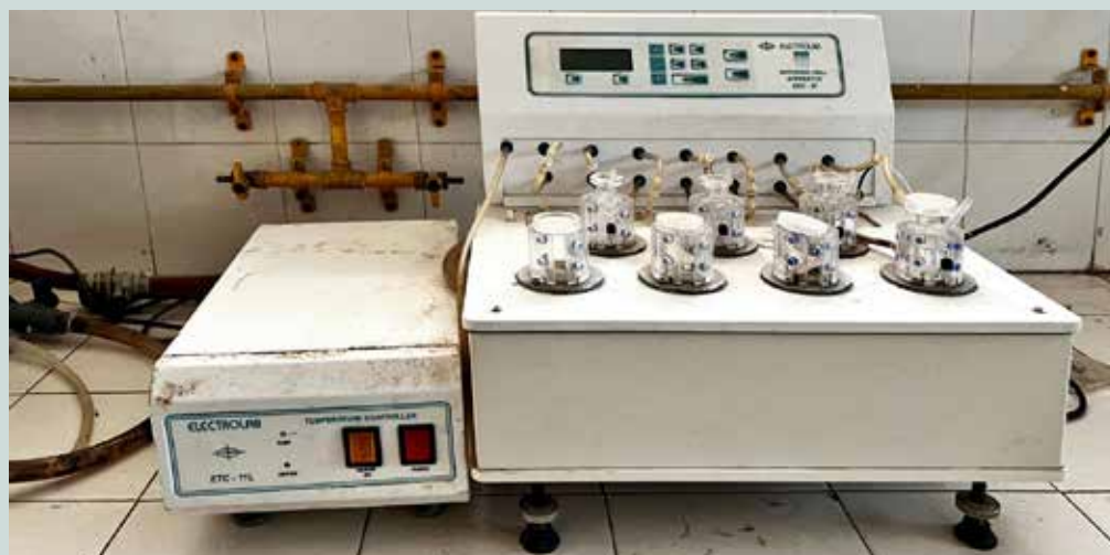
Diffusion Test Apparatus EDC-07, Electrolab
